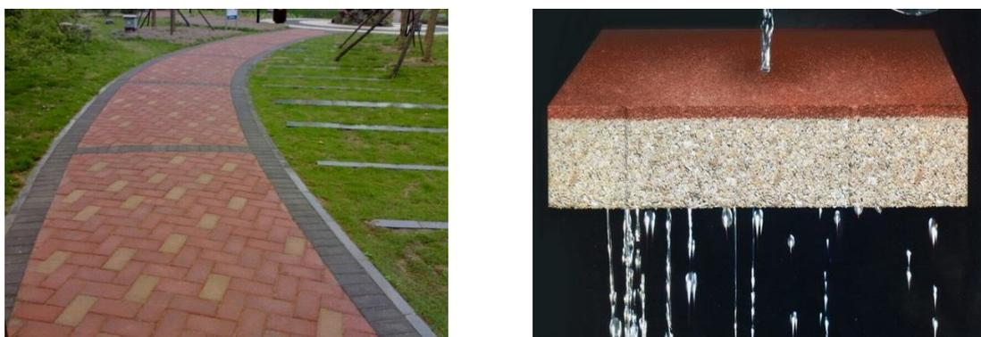
图 2-20 透水砖步道及透水砖透水试验
