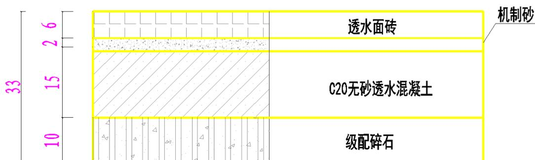
图 2-24 人行道路面结构图
